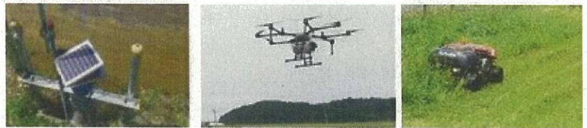
図7 右から遠隔水管理制御装置、農業散布用ドローン、ラジコン草刈機
