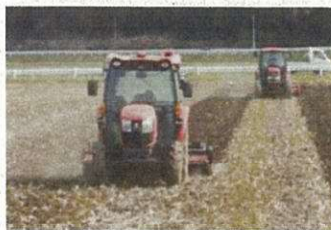
図1 GPSアシスト操舵トラクタと高速汎用播種機による作業時間の削減
