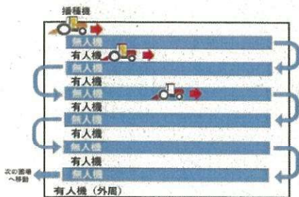
図2 大豆播種でのロボットトラクタ(無人)既存トラクタ(有人)との協調耕起作業
